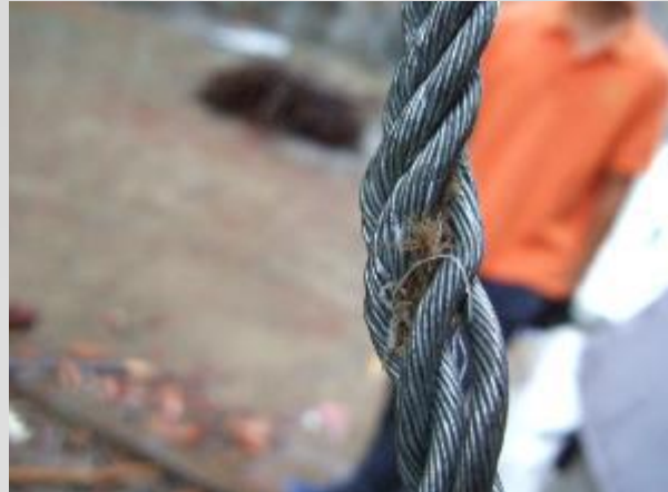
钢丝绳断口有明显的折弯 和挤压变形痕迹
