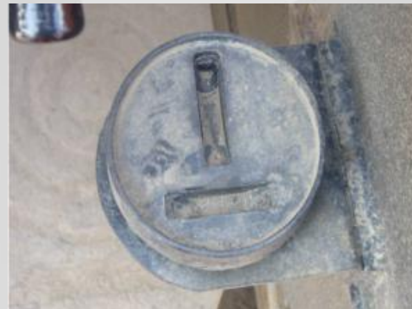
吊车水平装置损坏或缺失，无法保证车辆处于水平状态
