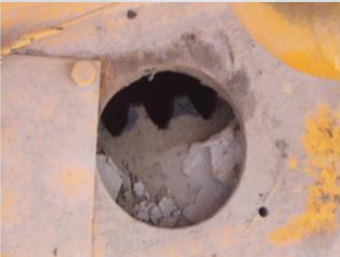
回转机构齿轮润滑不良，碎石、垃圾较多
