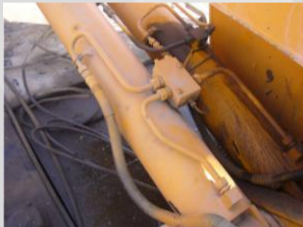
起升机构液压装置漏油
