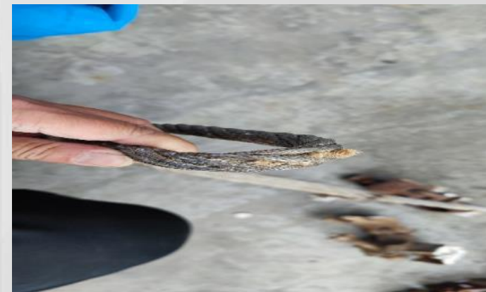
钢丝绳绳芯挤出、断股、散股等
