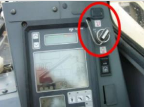
力矩检测器安全保护开关人为开启，失去保护作用
