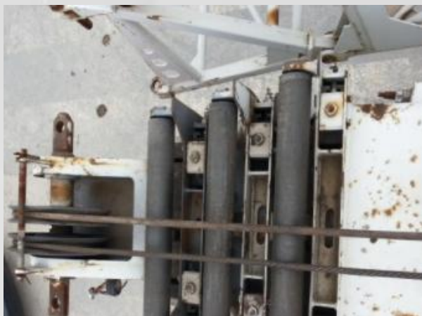
钢丝绳防脱装置与边缘间距小于钢丝绳直径的20%
