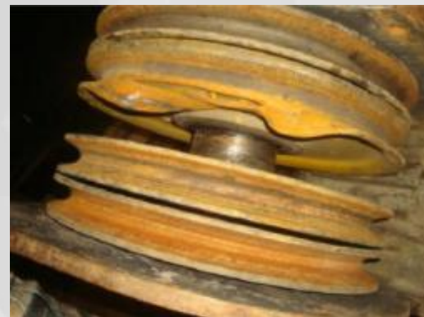
起升构件部位滑轮出现明显变形
