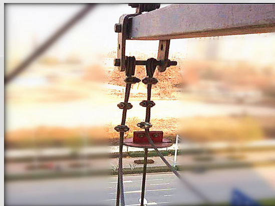
吊篮上行程限位挡块缺失且距悬挂点间距小于0.5m
