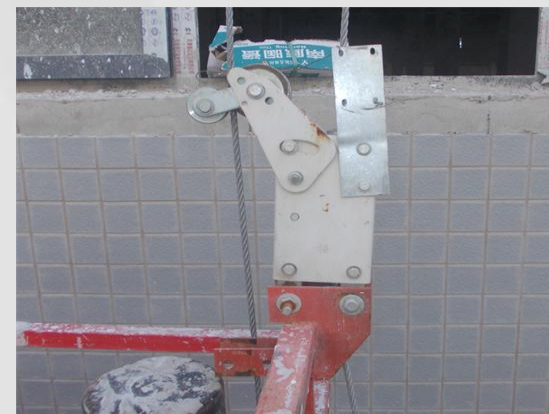
吊篮上行限位出发装置歪斜、失效、缺失，且安全锁开启手柄人为禁锢失效，安全锁铭牌缺失
