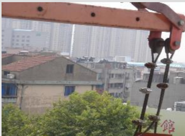
工作钢丝绳与安全钢丝绳 固定绳夹方向错误
