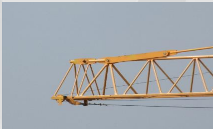
按要求塔吊起重臂前段未安装信号灯，塔臂风速仪失效
