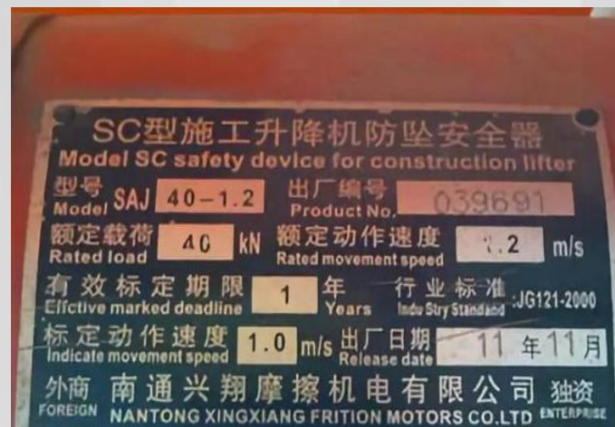
升降梯防坠安全器出厂日期距离使用时间超过5年
