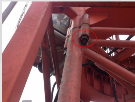
塔吊连接螺栓垫片缺失、安装松动，外露丝扣不足3P
